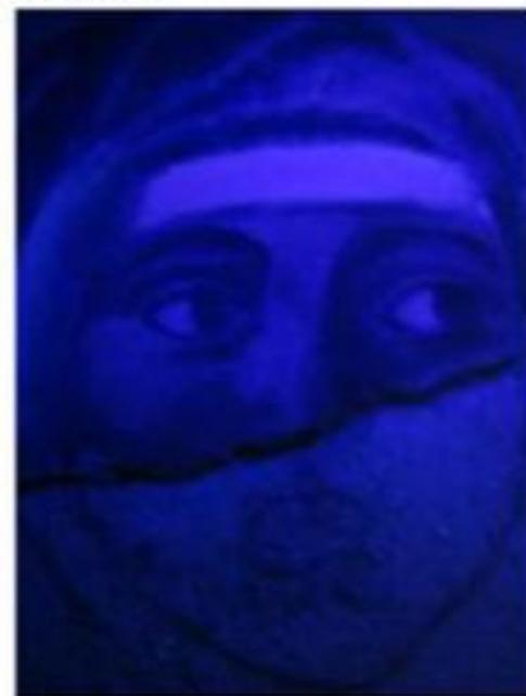
Un'analisi al microscopio sarà favorita da diverse sorgenti di luce. La fluorescenza emessa indicherà particolari sostanze organiche e permetterà indagini di mappatura topochimica (colorazioni specifiche di zone e sezioni ed identificazione delle sostanze)
