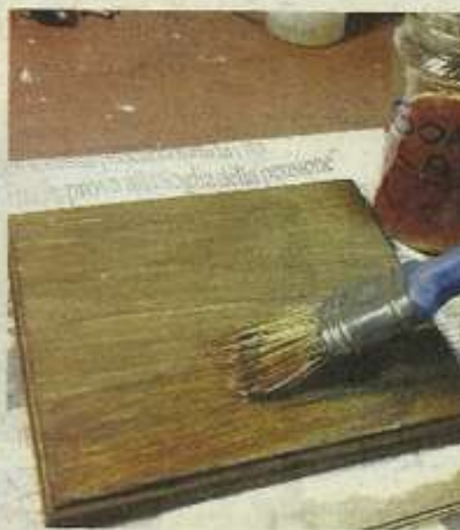
In alto da sinistra a destra la stesura della gommialacca, un violino pronto per essere verniciato e gommialacca in scaglie
