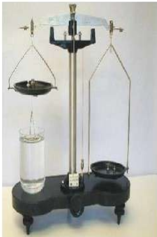
una bilancia analitica adattata a strumento per la misura della tensione superficiale
