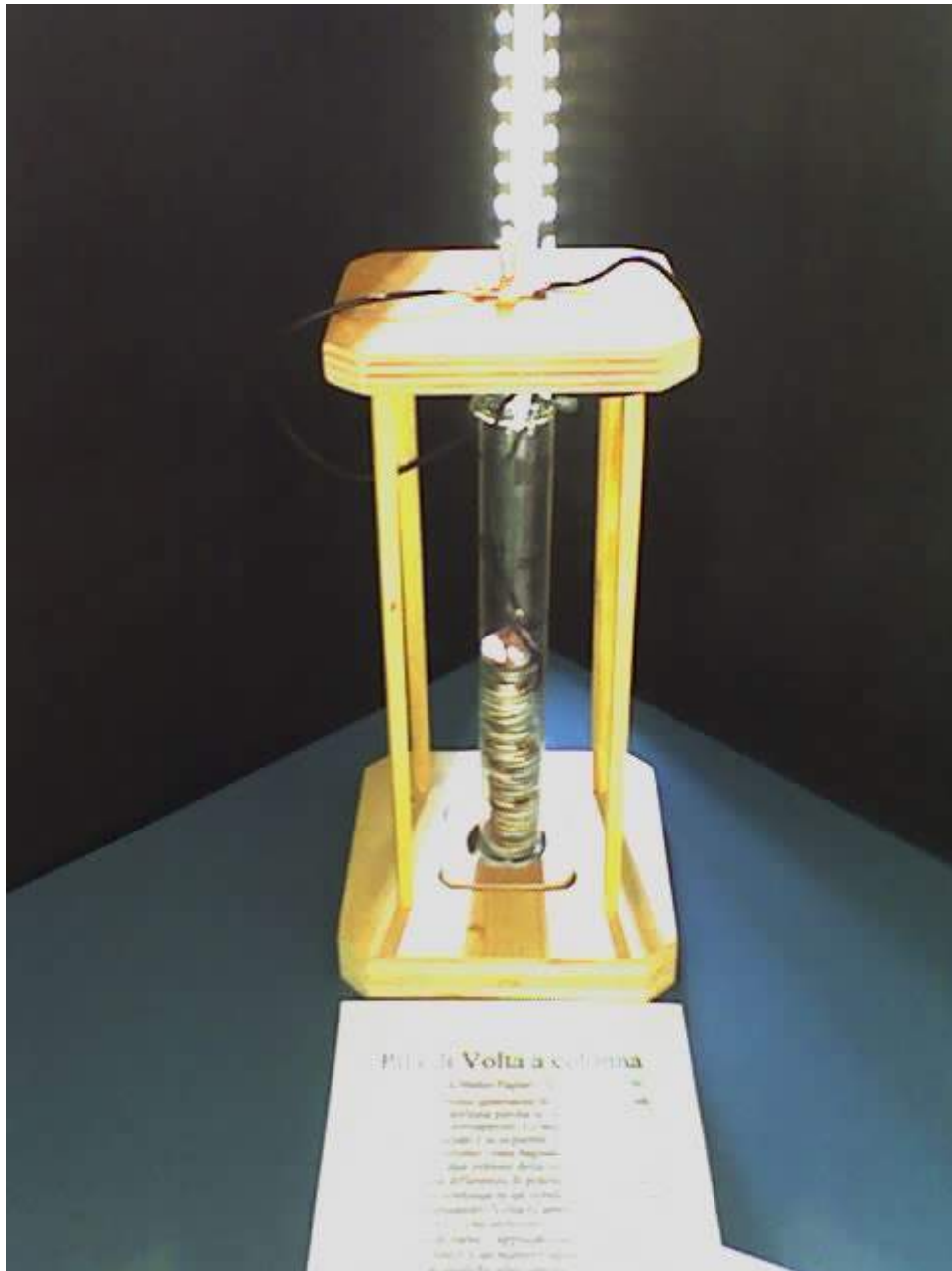
pila di Volta realizzata dagli studenti del ITIS Torriani
