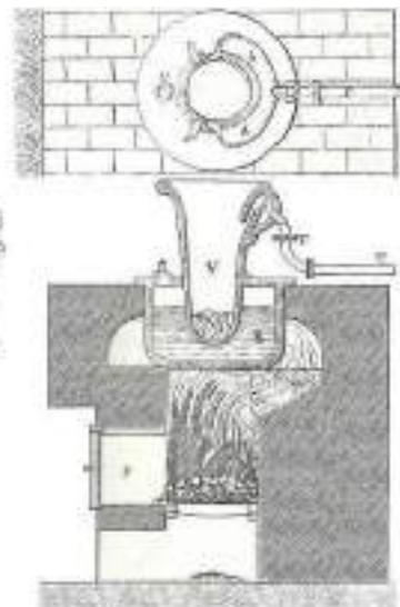
Apparecchio di distillazione di alcool per la fabbricazione di vernici
