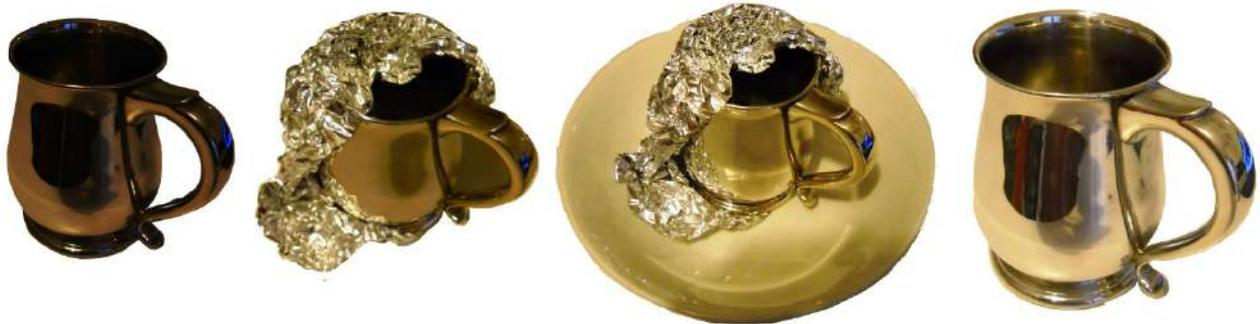
Un boccale d'argento ossidato è rivestito con lamina d'alluminio e posto in una soluzione di acqua e sali, debolmente acidulata.
